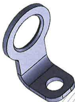
Bild 4: Anschlagpunkt, Typ: TS-Lasche (TS-011) (ohne Sollbruchstelle, mit Fase (2 x 45°))
