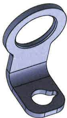
Bild 2: Anschlagpunkt; Typ: TS-Lasche (TS-106_V20) (mit Sollbruchstelle, ohne Fase)
